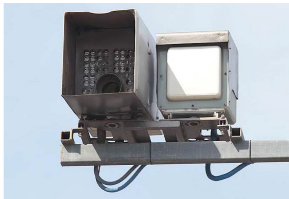
Рис. 1. Комплекс фотовидеофиксации «Стрелка-СТ»
