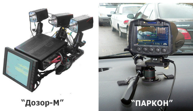
Рис. 2. Мобильные программно-аппаратные комплексы автоматической фиксации правонарушений для патрульных автомобилей
